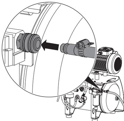
*Ilust. 1: Duo con separador de agua de condensación*
