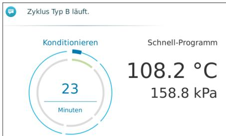
Im Überdruckbereich wird Dampf abgelassen und wieder erzeugt, dadurch wird die Beladung konditioniert.
