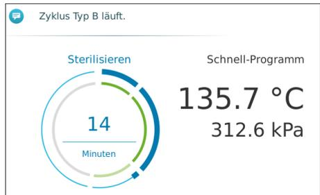
Im Inneren der Sterilisierkammer wird solange gesättigter Dampf erzeugt, bis die festgelegten Werte erreicht sind. Die eigentliche Sterilisation erfolgt während der vordefinierten Haltezeit. Am Ende der Sterilisationsphase wird der Druck abgelassen.
