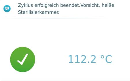
Am Ende eines Programms wird der Druck in der Sterilisierkammer dem Umgebungsdruck angeglichen.
