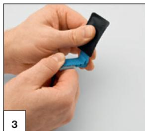
Speicherfolie in aufgebogener Halterposition entnehmen.
